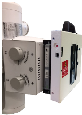
Exemple : Insertion d'une Chambre + un boîtier de radioprotection patient (RPS) Example: Insertion of a chamber + a box of radioprotection patient (RPS)
